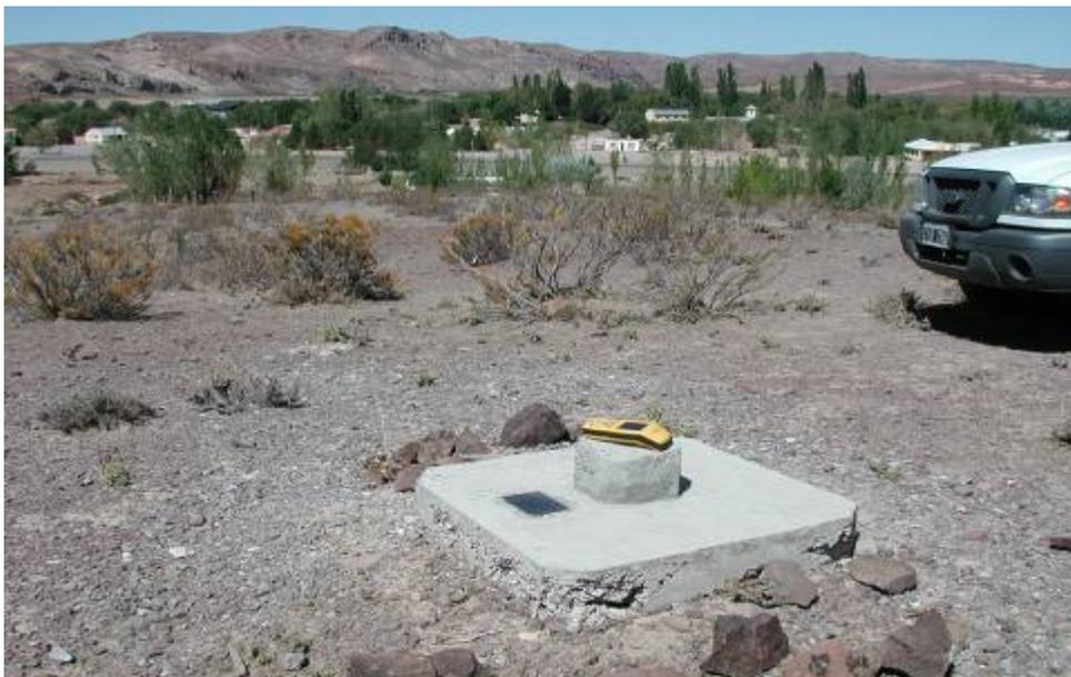
*Figura 4: Mojón del punto pasma 21-048, Las Plumas, Chubut. Sobre él el receptor Geoexplorer 3 tomando datos.*
