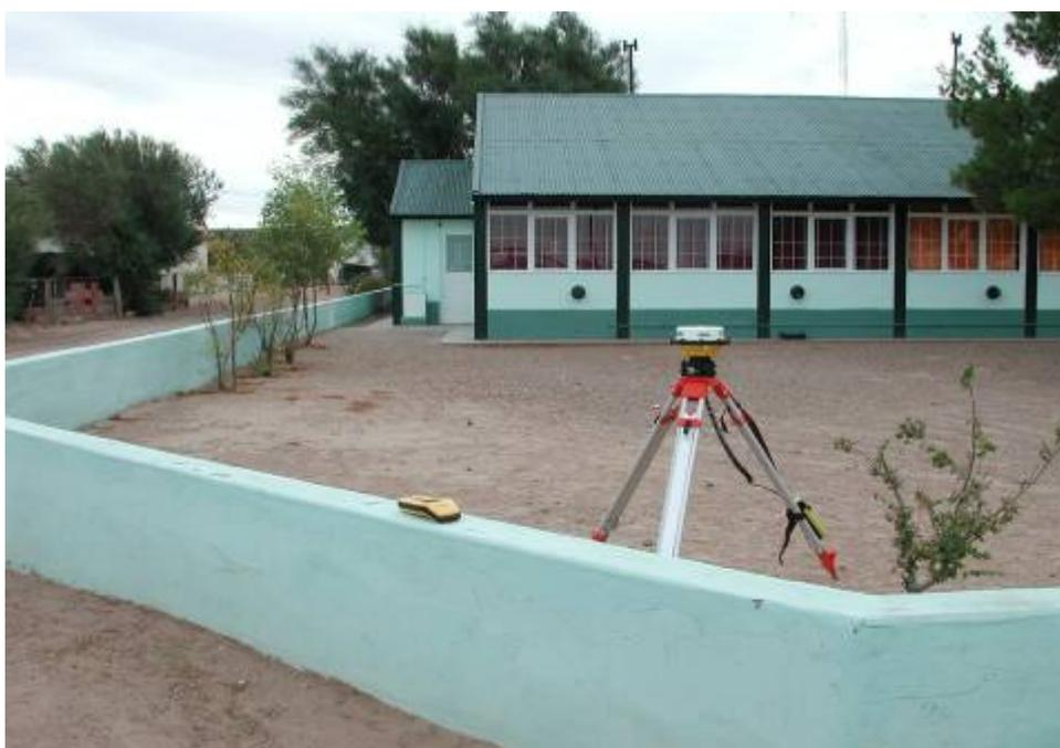
Figura 3: Sobre el trípode la antena SL 4600 y sobre el muro el receptor Geoexplorer 3.
