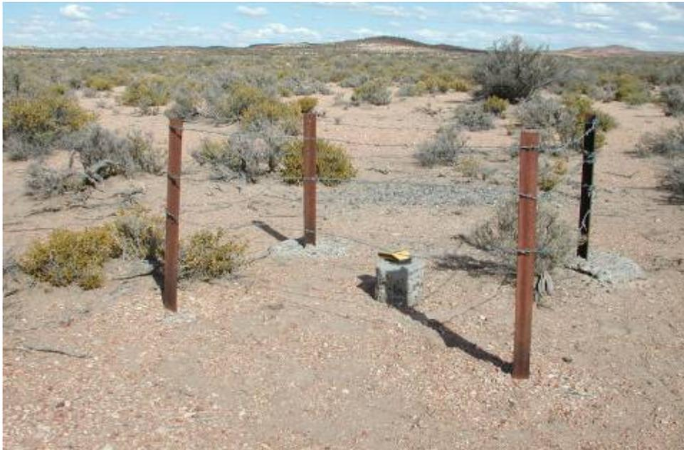
*Figura 5: Receptor GPS tomando datos sobre un punto de nivelación de la red del I.G.N.*
